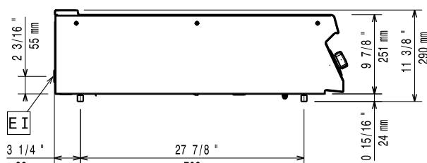
EI = Conexión eléctrica (energía)
